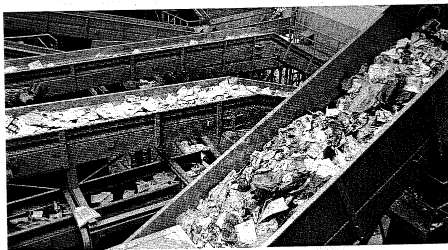
Bij de huisvuilscheidingsinstallatie in Amersfoort wordt huishoudelijk afval op een band gevoerd (foto boven) en gescheiden in verschillende fracties (foto midden). De verschillende deelstromen (foto onder) kunnen weer als grondstof worden ingezet.
